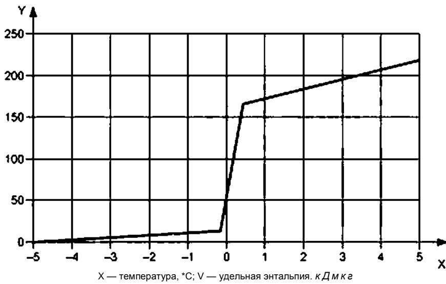
Рисунок 8 — Изменение значения удельной энталпии альтернативного наполнителя контрольных пакетов при изменении температуры
