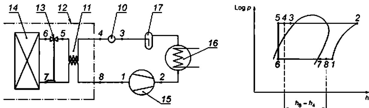
б) Схема подключения образца ТХО к выносному компрессорно-конденсаторному агрегату (системе)
