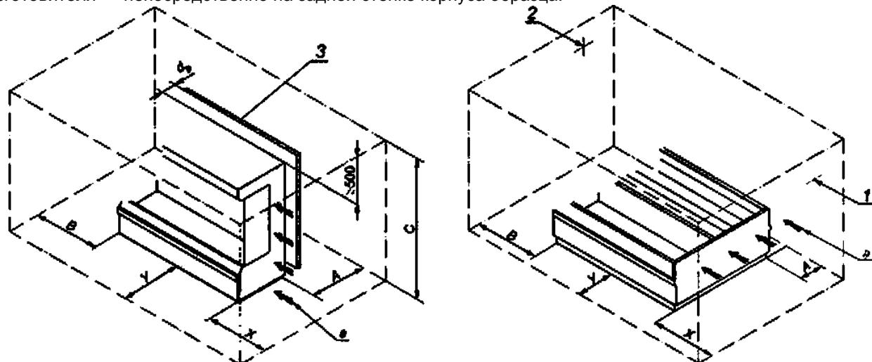
$d_p$  — расстояние от задней стенки образца до панели, предписанное изготовителем: 1 — боковая рабочая стена подачи воздушного потока в помещении для проведения испытаний, 2 — боковая рабочая стена отражения воздушного потока в помещении для проведения испытаний; 3 — вертикальная панель, устанавливаемая на задней стенке образца TXO (должна иметь те же высоту и ширину, что и испытуемый образец):
