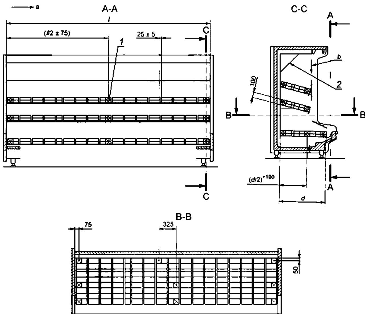
1 — длина шкафа,  $d$  — глубина основания полезного объема. } — гермометрический контрольный пакет;
