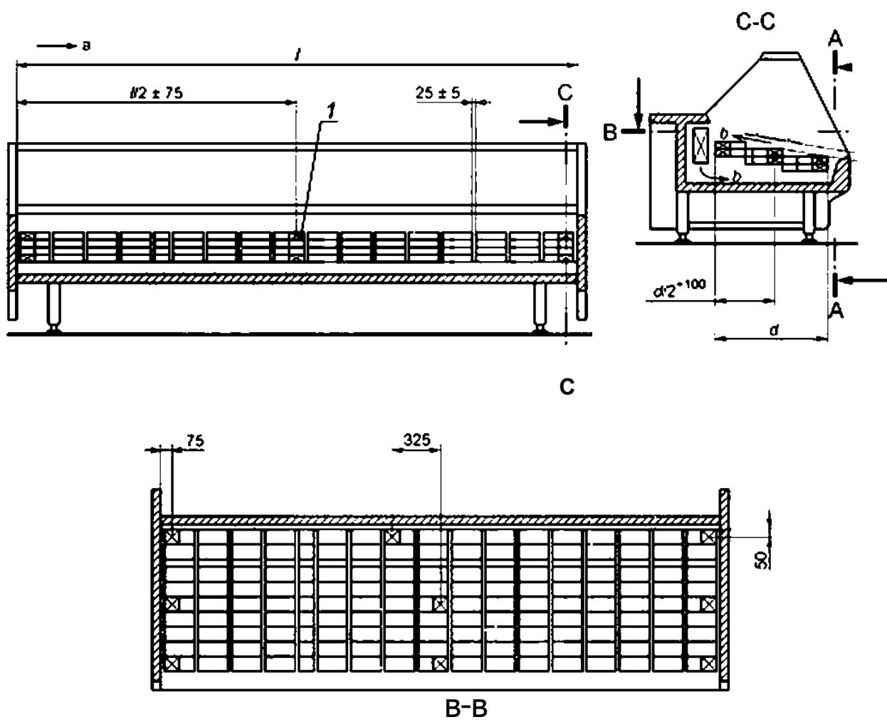
T — термометрический контрольный пакет; I — длина витрины; d — глубина основания полезного объема;
