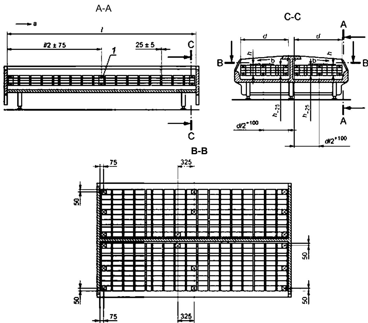
б) юризонталонах открытая двусторонняя витрина островного типа с охлаждением принудительным обдувоы и подачей воздуха от середины
