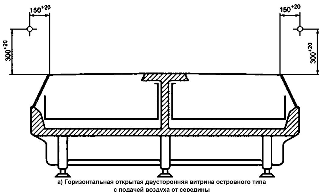
Рисунок 3. лист 1 — Точки размещения датчиков измерения температуры
