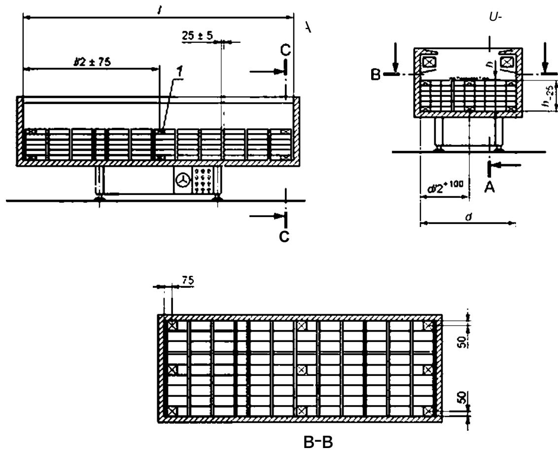
1 — термометрический контрольный пакет;  $f$  — длина витрины,  $d$  — глубина основания полезного объема.
