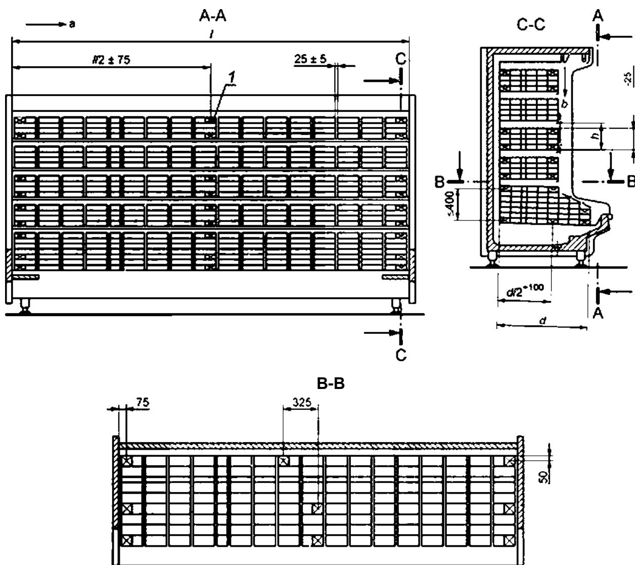
1 — термометрический контрольный пакет; / — длина шкафа; d — глубина основания полезного объема.
