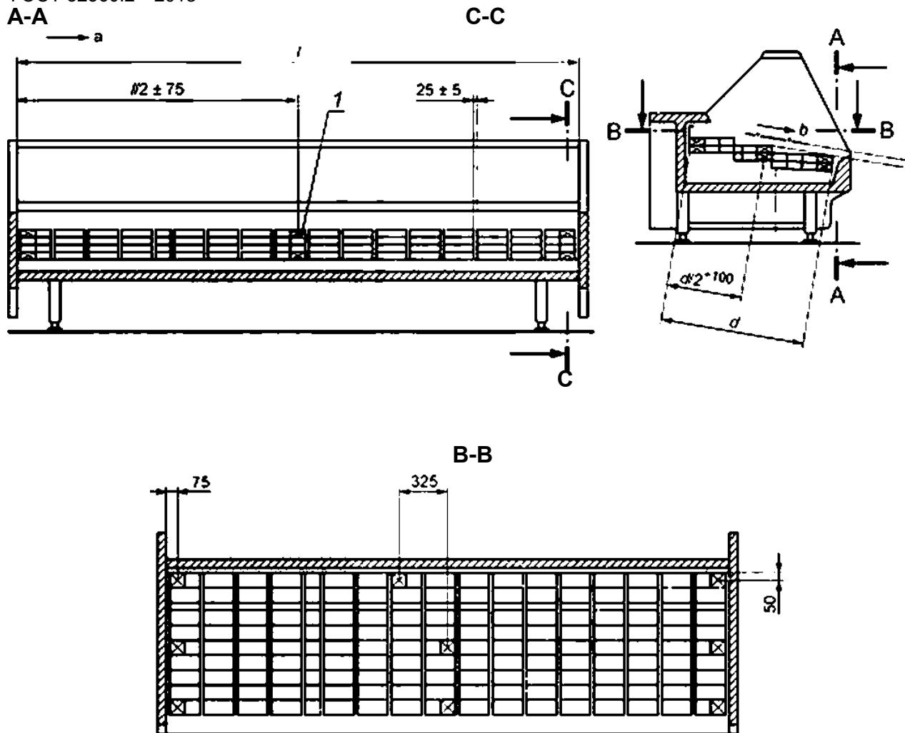
} — термометрический контрольный пакет;  $l$  — длина ентрны;  $d$  — глубина основания полезного объема,
