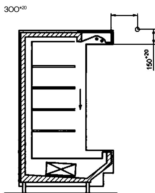
Рисунок А — Точки размещения датчиков измерения температуры и относительной влажности окружающего воздуха в помещении для проведения испытаний типичного образца вертикального открытого многоярусного шкафа
