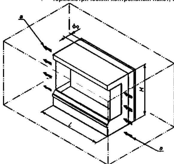
$dp$  — расстояние от задней станики образца до панели, предписанное изготовителем;  $I$  — высота воздушного канала (равна высоте шкафа);  $L$  — длина воздушного канала (равна длине шкафа); а — направление воздушного потока
