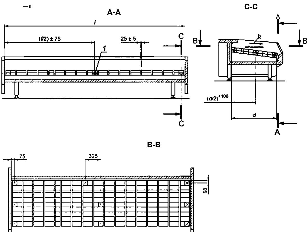
1 — термометрический контрольный пакет.  $l$  — длине витрины;  $d$  — труба основания полезного объема;
