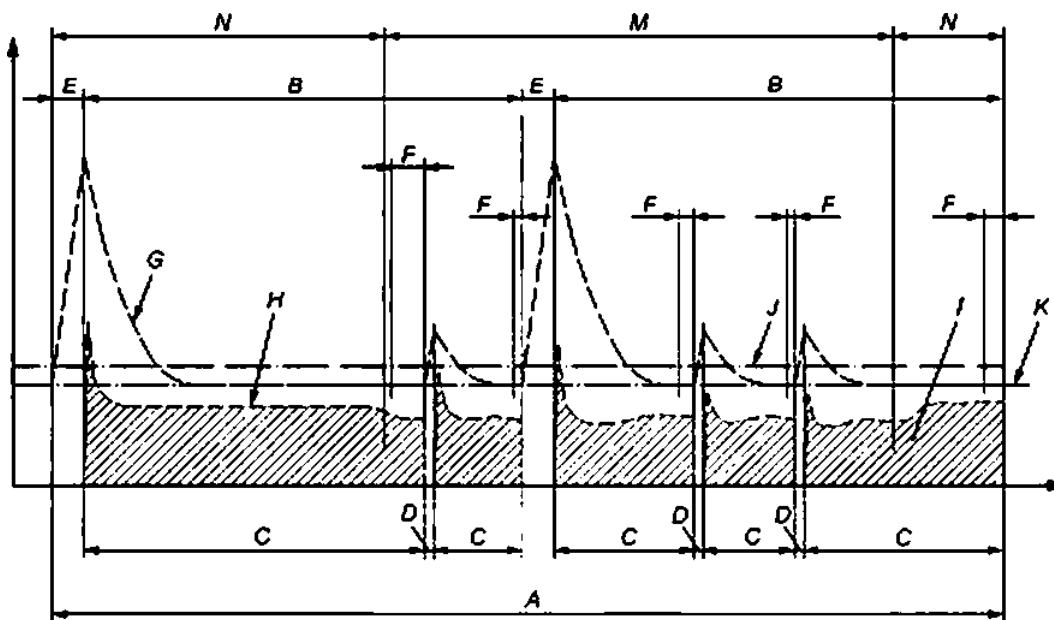
б) Постоянное давление кипения, установившийся режим, меустановившийся режим с ночных крышками
