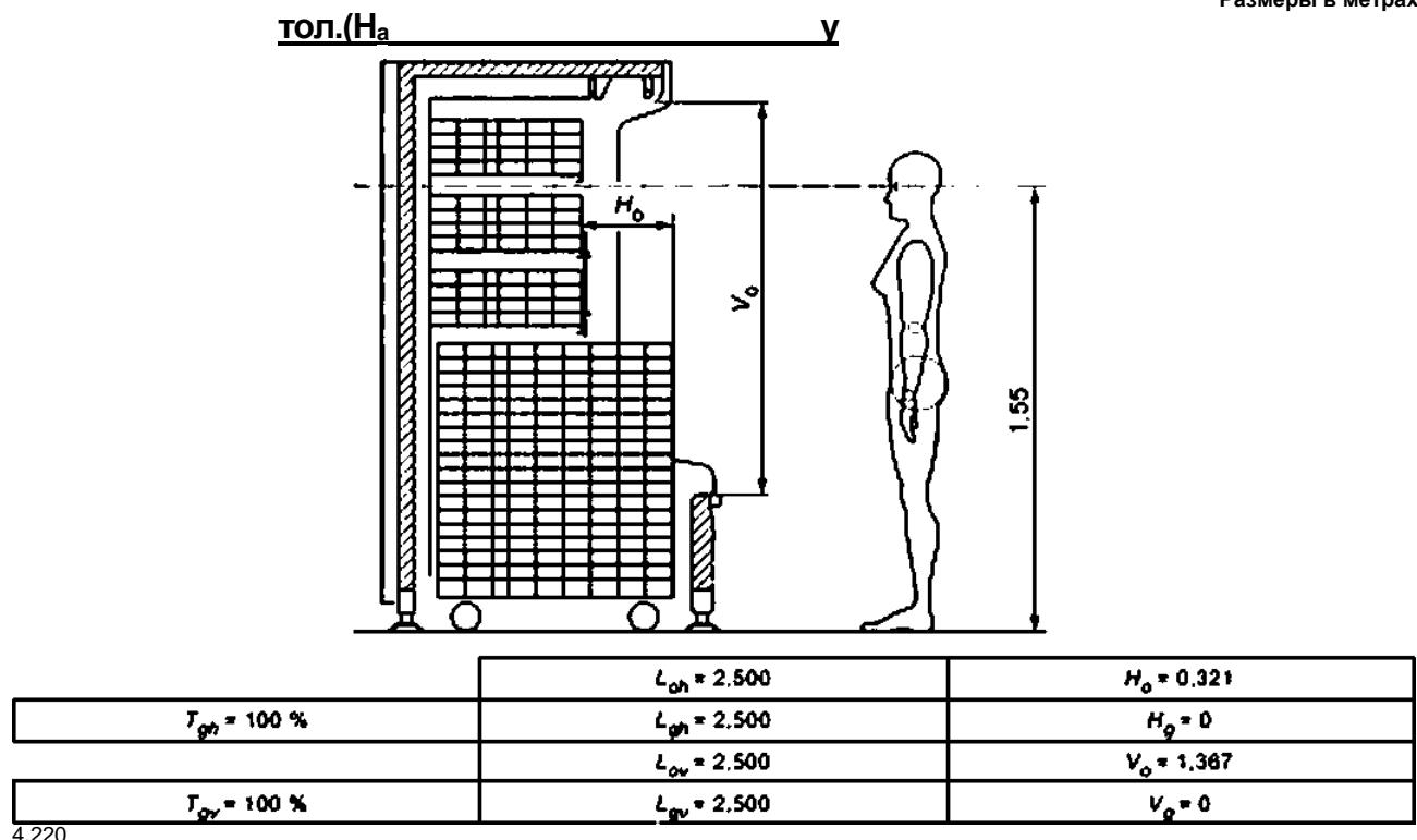
Рисунок А.4 — Вертикальный переавижной шкаф
