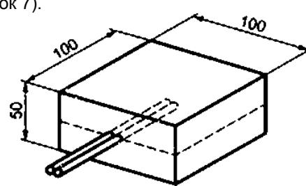
Рисунок 7 — Термометрический контрольный пакет
