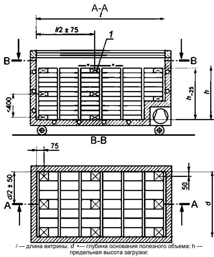
Рисунок 20 — Размещение контрольных пакетов, в том числе термометрических, в горизонтальном закрытом ларе островного типа со стеклянной крышкой и ступенчатым днищем полезного объема при наличии или отсутствии теплообменных труб
